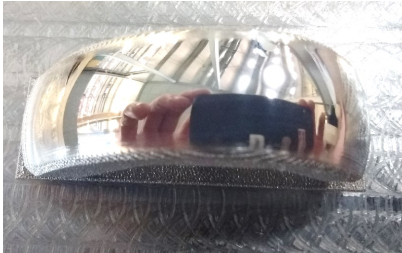
Pièce polie sur centre d'usinage
