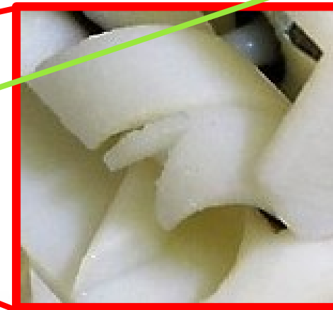
Mécanisme pignon-crémaillère compliant
