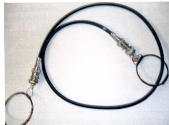
Antenne accordée sur la fréquence du RFID
