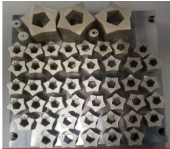
Fusion laser sur lit de poudre (powder bed fusion-laser beam, PBF-LB)
