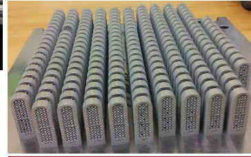
Fusion laser sur lit de poudre (powder bed fusion-laser beam, PBF-LB)
