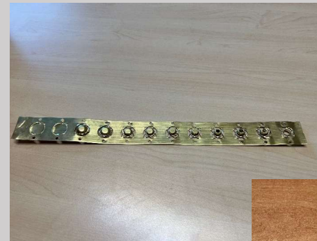
Exemple d'Outil de découpe/emboutissage à 12 postes :
