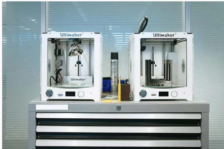
Le lieu d'installation d'une imprimante 3D est de fait requalifié en "local à pollution spécifique".
